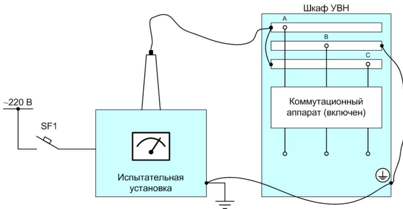
Рисунок 19 - Испытание УВН по схеме «*полюса ф. А, С - полюс ф. В и корпус шкафа*»
