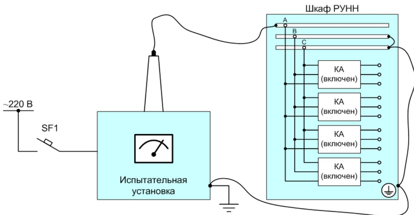
Рисунок 17 - Испытание РУНН по схеме «полюс – остальные полюса и корпус шкафа»
