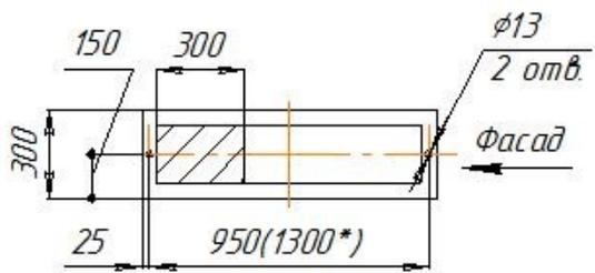
Отверстия для ввода контрольных и силовых кабелей в релейный шкаф
