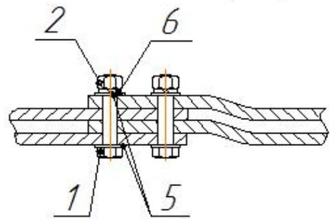
Вариант соединения алюминиевых шин
