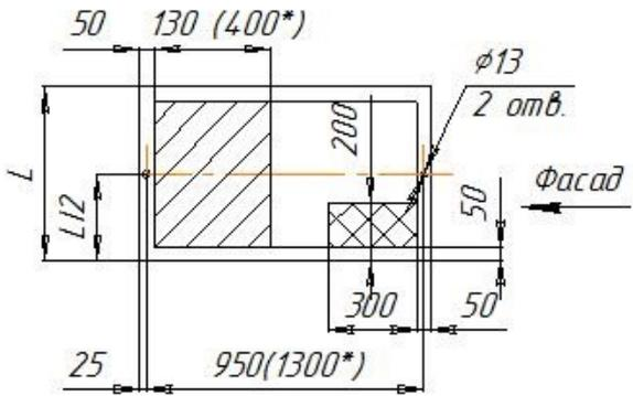
Отверстия для ввода контрольных кабелей в вводной шкаф (L=600, 800, 1200):
