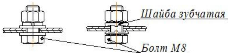
Рисунок 6 - Стыковка шкафов РУНН
