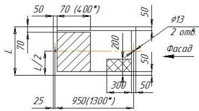
Отверстия для ввода контрольных и силовых в линейный шкаф (L=500, 600, 800мм)
