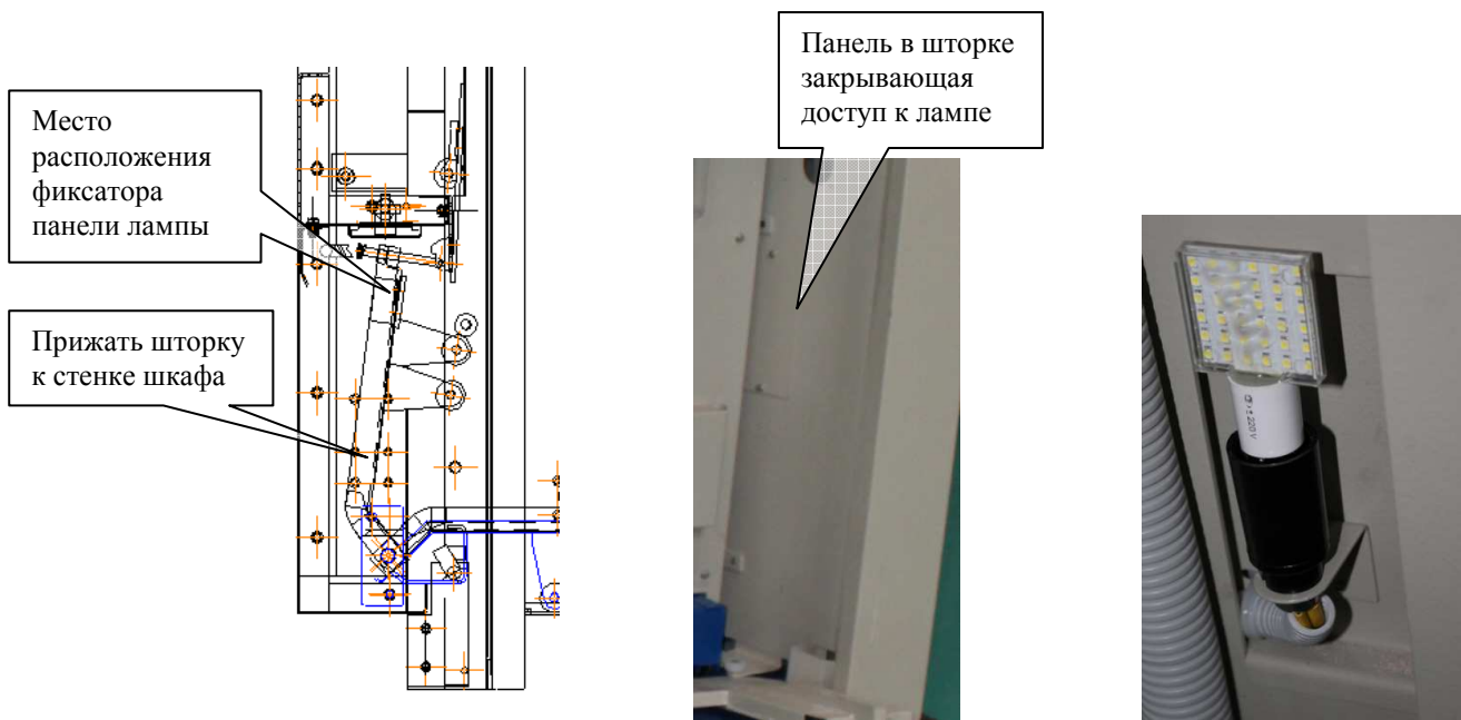
а) Замена лампы в шкафах шириной 1000 мм
