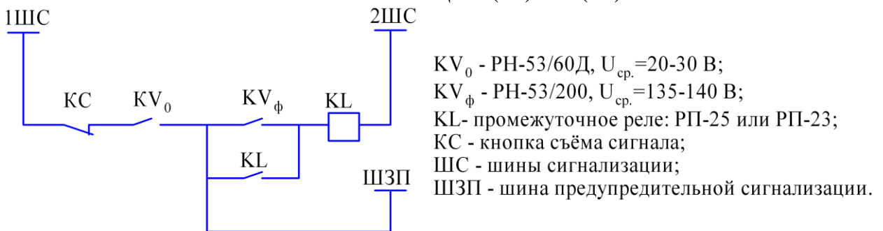
Рисунок Б.2 Автоматическая схема оперативных цепей защиты от феррорезонансных процессов
