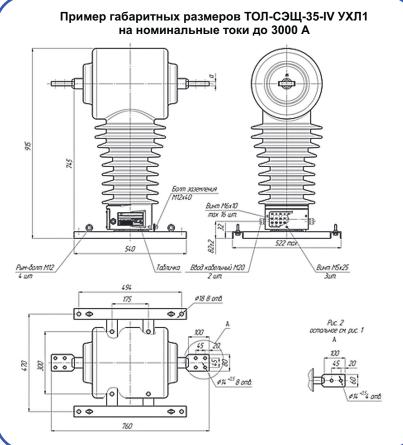
**Трансформатор тока ТОЛ-СЭЩ-35-IV** обеспечивает передачу сигнала измерительной информации приборам измерения, защиты, автоматики, сигнализации и управления, предназначен для использования в цепях коммерческого учета электроэнергии в электрических установках переменного тока на класс напряжения до 35 кВ. Трансформатор изготавливается в климатическом исполнении "УХЛ" и "Т" категории размещения 1 по ГОСТ 15150-69.
