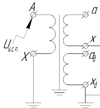
Рисунок 1 - Схема испытания электрической прочности изоляции первичной обмотки трансформатора приложенным напряжением 1,3 номинального при частоте 50 Гц
